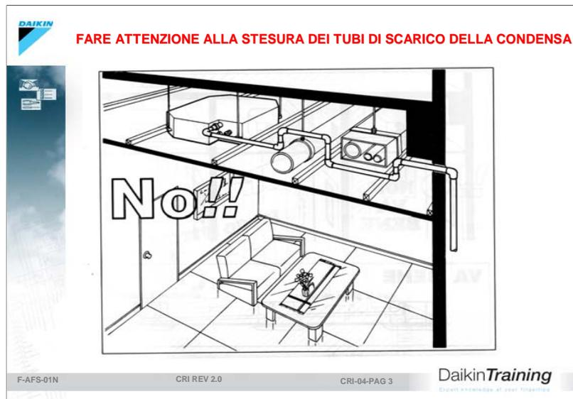
Ricordare che la tubazione di scarico deve sempre procedere in pendenza verso lo scarico e che l'acqua non deve mai riempire il tubo completamente altrimenti lo scarico diventa incerto. Evitare i tubi in "contropendenza" anche se la macchina è provvista di pompa poiché quando la pompa si ferma l'acqua torna indietro e causa l'arresto del condizionatore in emergenza.
