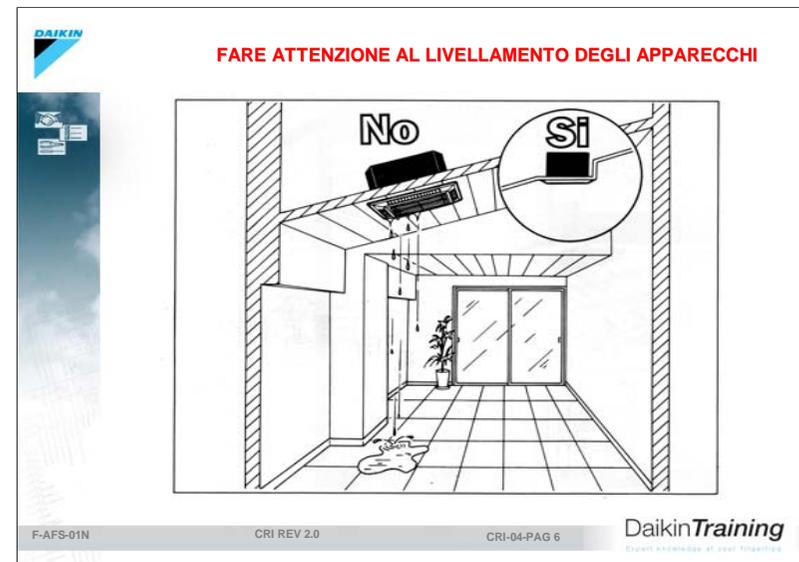
Le unità interne devono essere montate esclusivamente in posizione orizzontale per permettere il regolare accumulo e scarico dell'acqua di condensazione
