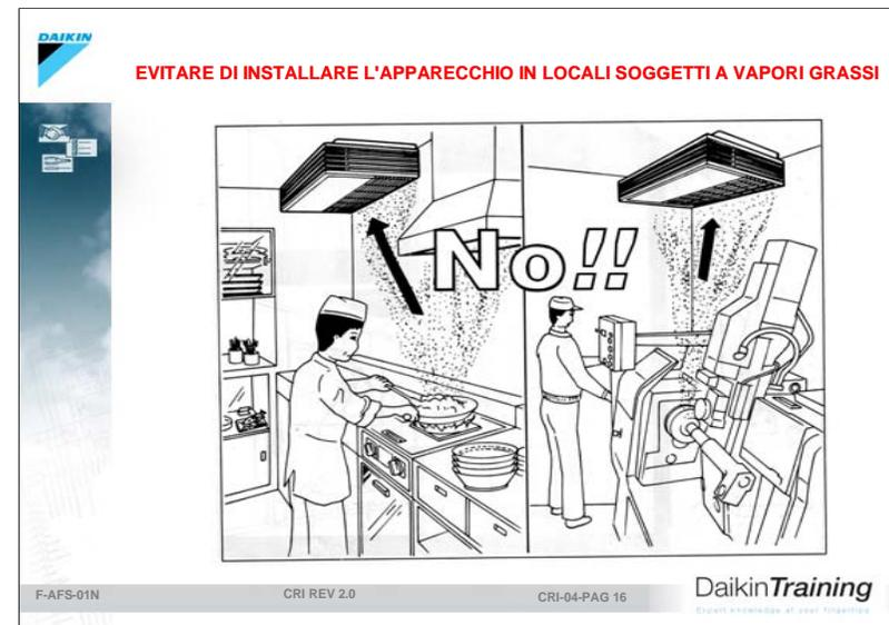
Allontanare gli apparecchi da sorgenti di vapori grassi che finirebbero inevitabilmente per sporcare gli scambiatori causando cali di rendimento, malfunzionamenti e cattivi odori.
