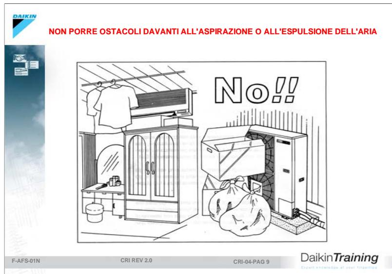
L'aria necessaria al funzionamento dell'unità esterna deve poter essere aspirata e scaricata liberamente. Ogni ostacolo causa aumento del consumo elettrico e una diminuzione delle prestazioni e nei casi più gravi il blocco o la rottura della macchina. Lasciare chiare istruzioni in merito a chi dovrà utilizzare il condizionatore.
