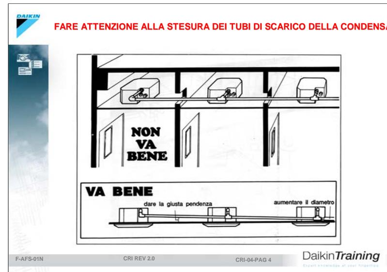
Ricordare che alcuni apparecchi hanno incorporato una pompa di innalzamento dell'acqua e che pertanto, in caso di scarico multiplo l'impianto dovrà essere realizzato in modo da evitare che l'acqua di una macchina con la pompa in funzione possa entrare in un'altra che in quel momento ha la pompa ferma.
