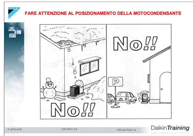
Il posizionamento della motocondensante esterna dovrà considerare anche possibilità di problematiche possibili o future, come l'accumulo di neve o situazioni variabili che possano in qualche maniera danneggiarle od impedirne il regolare funzionamento.
